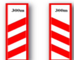
(T-28a,b) DEMİRYOLU HEMZEMİN GEÇİT YAKLAŞIMI (Sağ, Sol)
